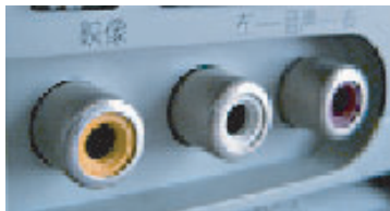
(接続例 1) 車載のビデオ映像/音声入力端子 (RCA) (接続例 2) 市販モニター/ナビのビデオ映像/音声入力端子 (RCA)
