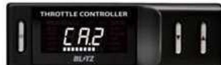
走行状態に合わせて自動的に比率が変化する『オートモード』を、ドライバーの好みによってカスタマイズが可能になった新モード。オートモード内部の7段階の変化比率をお好みに設定していただくことで、自在なセッティングを実現します。カスタムオートモードは、2モードそれぞれカスタマイズが可能で状況に合わせた2モードをメモリーすることができます。
