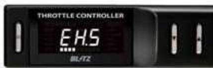
通常モデルよりさらに比率を落としよりエコランを実現するHYBRID CAR専用モード。従来品の倍となる、6モード。
