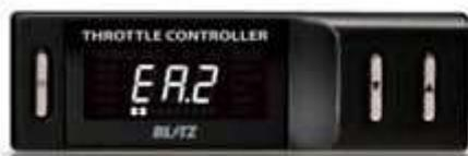
従来のオートモードをエコドライブ向けに調整した新モード。エコモードベースに、走行状態に合わせて比率が自動的に可変します。特性の異なる2つのモードから選択することができます。
