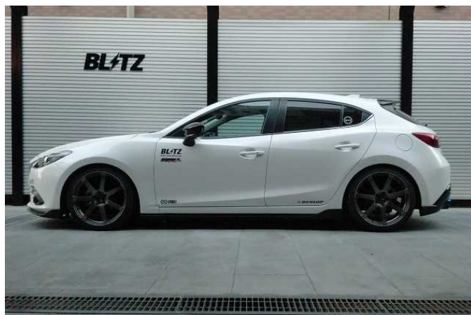
フロント:-40mm ダウン / リア:-45 mmダウン ※上写真はアクセラスポーツ(BM2FS)になります
