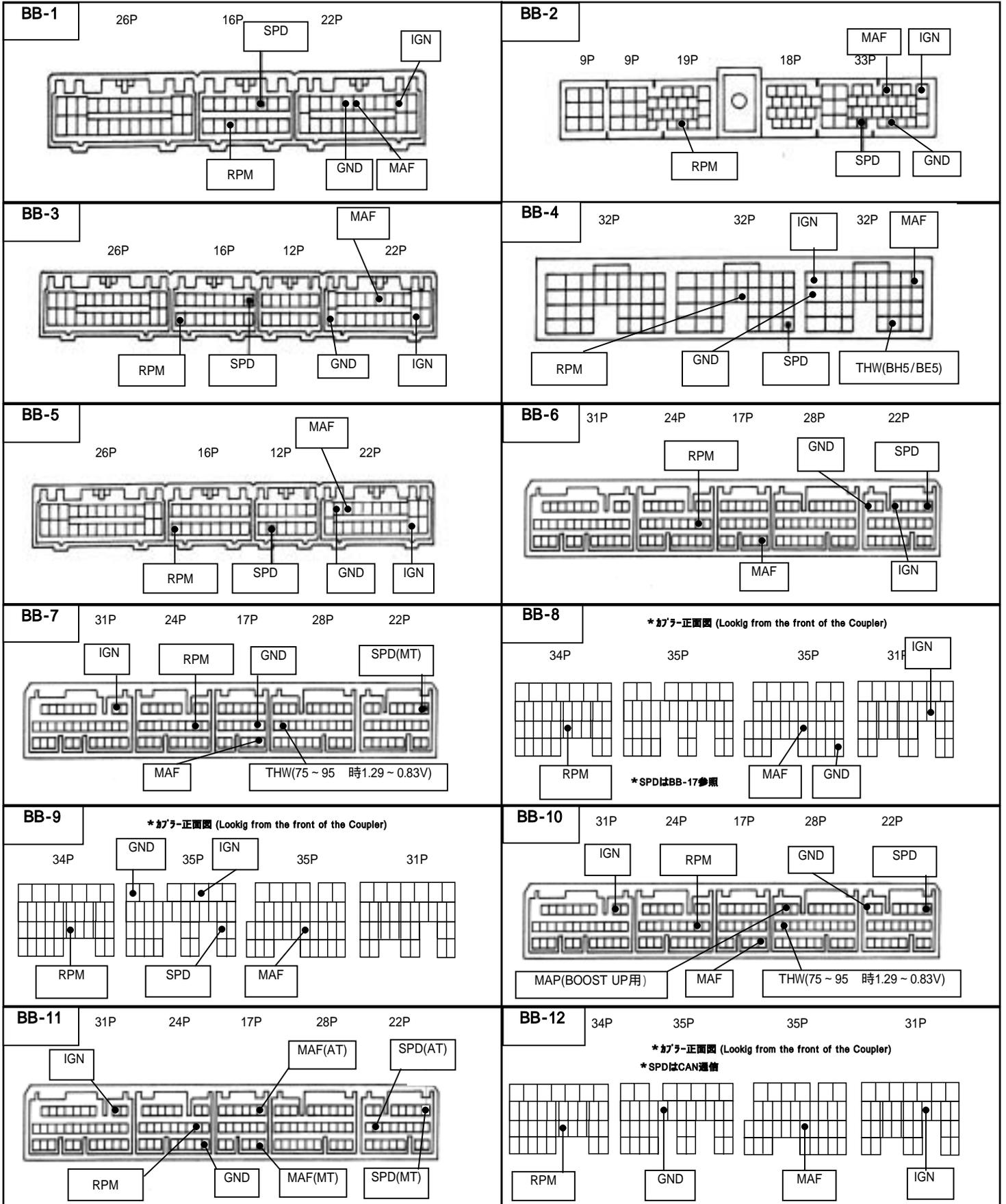
IGN:イグニッション電源 GND:アース RPM:回転信号 IGT:点火信号 SPD:車速信号 MAF:エアフロ信号 MAP:圧力信号 THW:水温信号 VTA:スロットル信号
