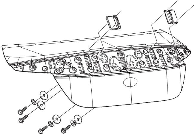
⑥ トランクリッドに付属⑤台座を付属のスプリングワッシャー・ワッシャー及び M6 ボルトで仮固定をしてください。
