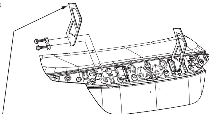
⑥ 付属④ウイング脚を台座に M6 ボルトとスプリングワッシャーで固定してください。図はロング版の脚です。
