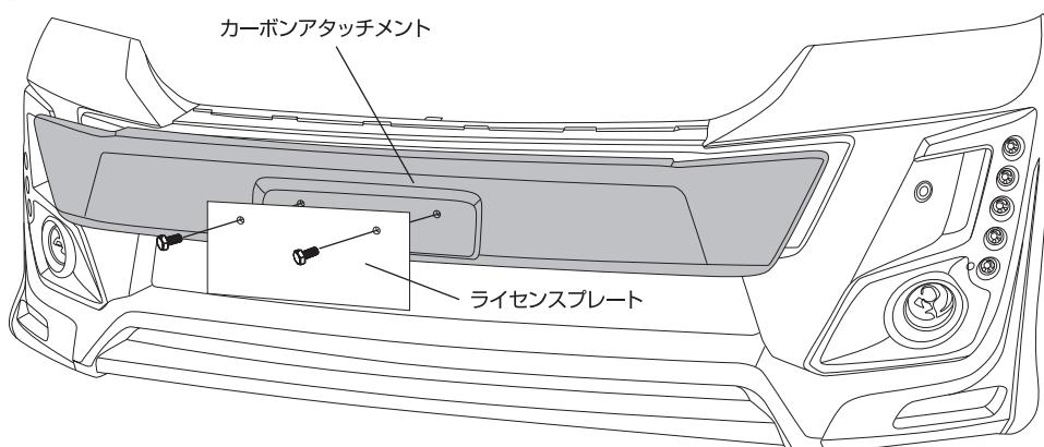
⑤F/CAを②にてマーキングした取付位置にしっかりと合わせ、F/CAをF/Bに被せます。F/CAをF/Bから若干浮かせ、両面テープの剥離紙が切れないように徐々に剥がし、中央部分から外側に向かってF/CAをF/CA表側とF/B裏側から押しながら浮きが出ないように両面テープ部分を貼付けます。
