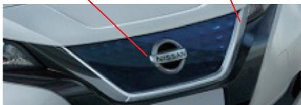
①-3. 純正オーナメントパネルの赤丸で示した部分は製品裏面の突起に緩衝しますのでカットしてください。
