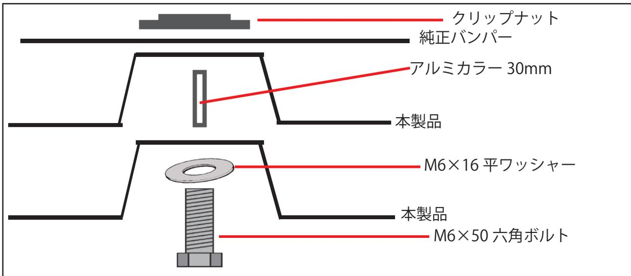
⑦ 純正のスクリューを使用しバンパーと本製品を共締めで固定します。
