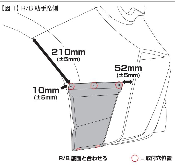
②図 1 を参照に、R/B ATT を R/B に仮合わせし、取付位置をマスキングテープ等を利用してマーキングし、製品に開いている取付穴位置を R/B にマーキングします。(図 1 参照)
