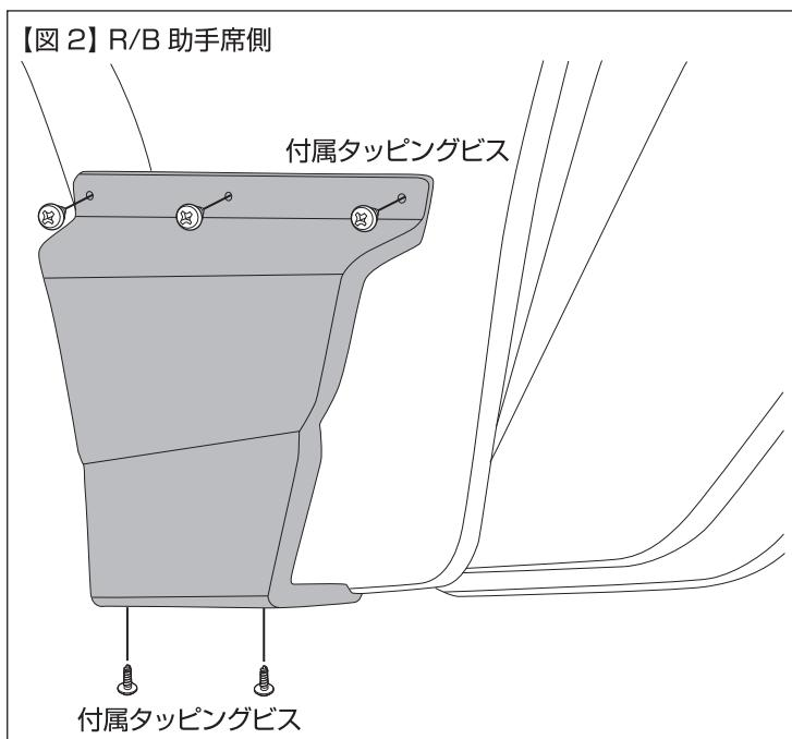
⑤R/B ATT をマーキング位置にしっかりと合わせ、③にて開けた取付穴を利用して、付属の M4 タッピングビスにて片側 5 箇所づつ取付ます。(図 2 参照)
