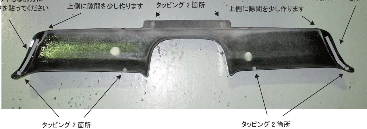
⑥付属の両面テープを本製品裏側に貼り付けます。＜上図参照＞ \*尚、この際製品裏側はしっかりと脱脂したのち、両面テープを貼って下さい。さらに、両面テープの剥離紙の最端部をすこし剥がし、R/DF表面に折り曲げマスキングテープ等で固定します。
