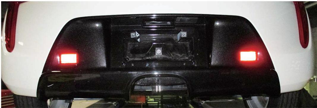
④R/DF 上部 2 箇所と下部 4 箇所の取付け穴からリアバンパーに穴位置をケガキ針やガビョウでガイド穴を開け、付属の M4×16 タッピングスクリューにて締込みながら取付けます。
