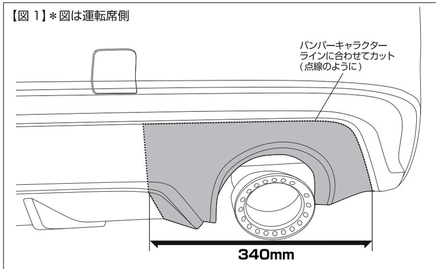
②車両バンパーを左図を参照にカットして下さい。(図1参照・左右)
