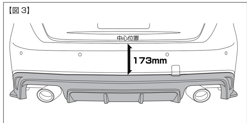
③純正バンパー下面先端部分 (左右) 及び中央付近の 2箇所 のクリップを取外して R/DF を仮付けし、取付位置に合わせてバンパーにマスキングテープ等を利用してマーキングして下さい。この際取付位置は図 2, 図 3 を参照に、R/DF 後端部からバンパーエンドまでが 375mm(±2)。R/DF センター部分からバンパー上部までが 173mm(±2) になるようにして下さい。(図 2, 図 3 参照)
