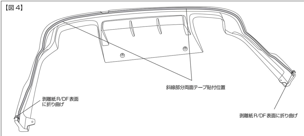
⑤付属の両面テープを本製品裏側に貼り付けます。\*尚、この際製品裏側はしっかりと脱脂したのち、両面テープを貼って下さい。さらに、両面テープ剥離紙の最端部をすこし剥がし、R/DF 表面に折り曲げマスキングテープ等で固定します。(図4参照)
