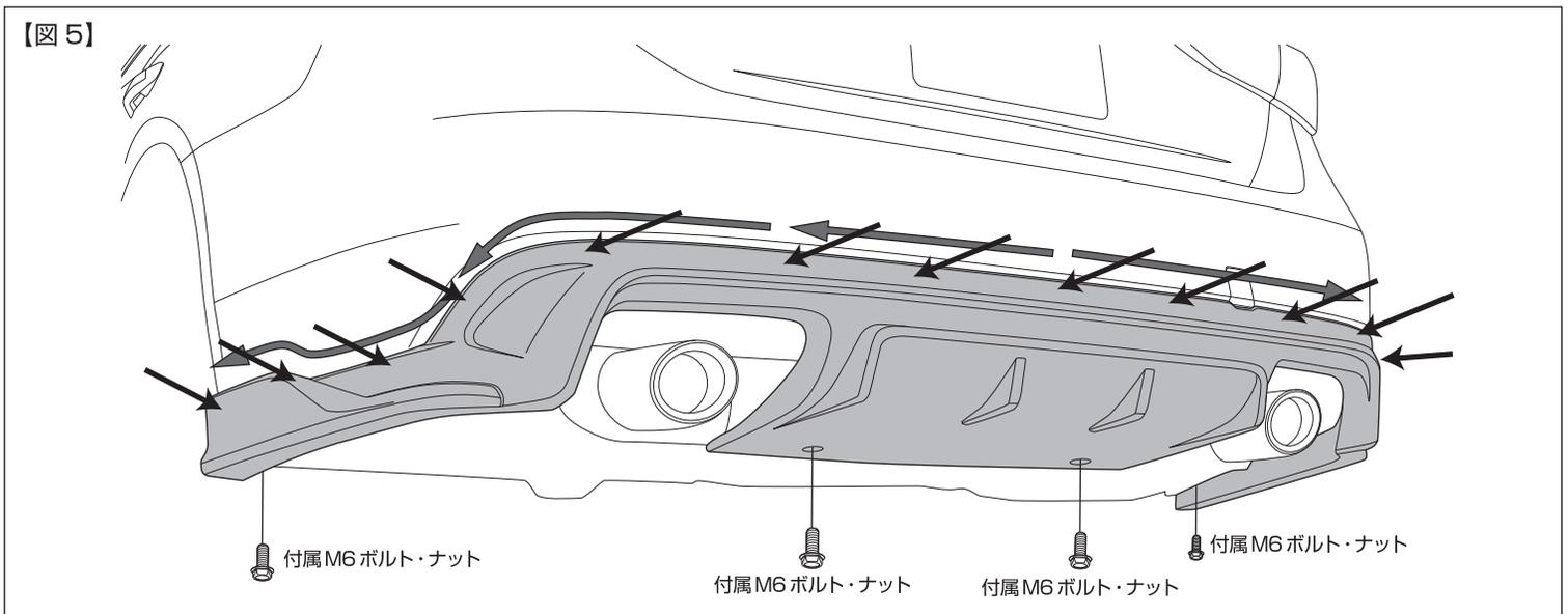
⑥純正リアバンパー R/DF 取付位置の汚れや油分をしっかりと取除き、R/DF をバンパーに被せマーキング位置に合わせます。R/DF をバンパーから若干浮かせ剥離紙が切れないように徐々に剥がし、R/DF を取付位置にしっかりと合せ、中央部分から外側に向かって R/DF を押しあてながら浮きが出ないように両面テープ部分を貼り付けます。(図5参照)
