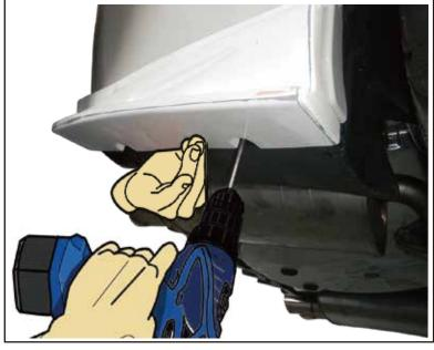
④本背品に付属の両面テープを貼り、付属のタッピングを使用し固定します。
