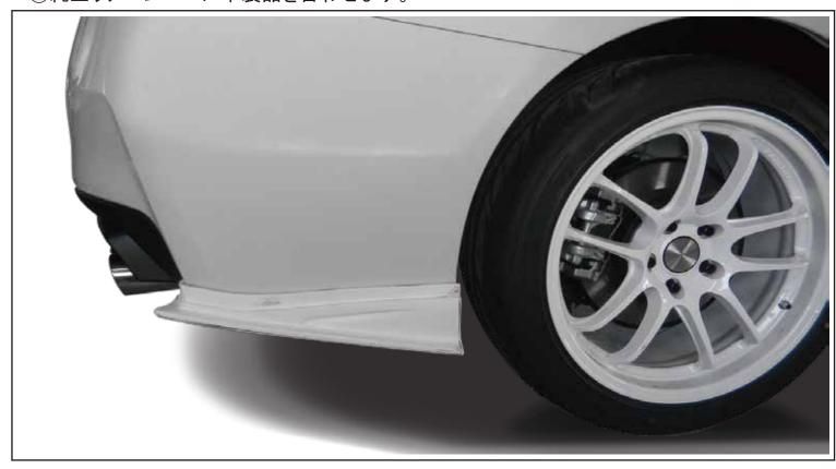
③車両と製品の位置に問題がなければ、製品側の取り付け穴をガイドにし「3.2mm」のドリルで下穴を開けます。
