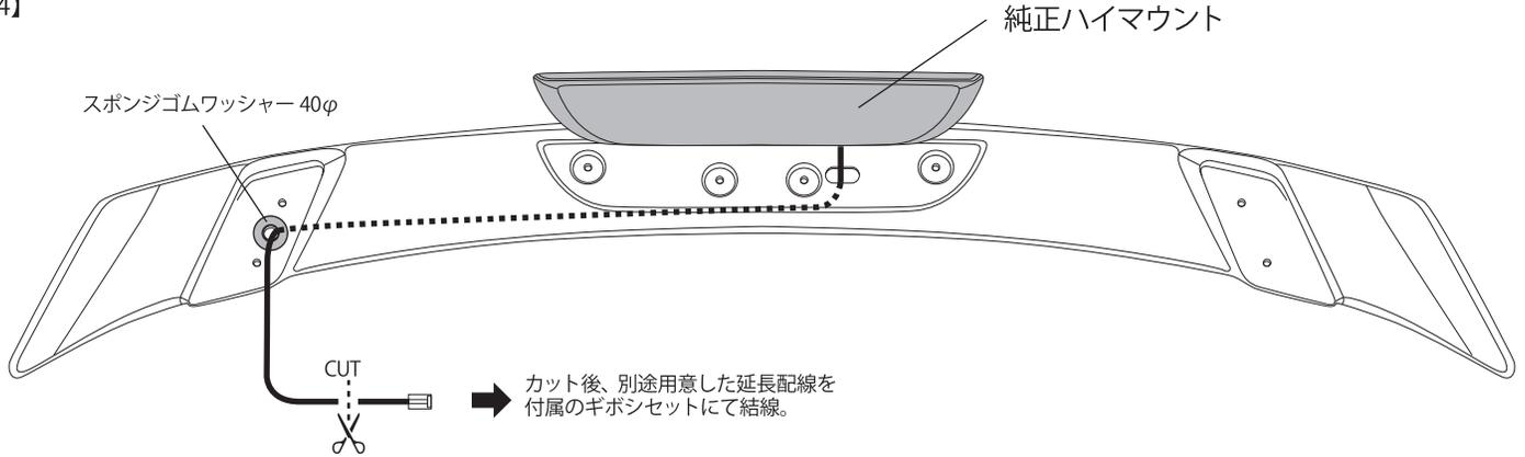
⑨②にて取外した、純正ハイマウントをR/Wにエポキシ系接着剤を使用して移設します。しっかりとR/Wと接着されているか確認してください。この際、配線カプラー部分から配線を5cm程度残してカットしてから、別途ご用意して頂きました延長配線を、付属のギボシセットにて接続したら、配線をR/W内部を通し、配線穴から通します。さらに、付属のスポンジゴムワッシャーを配線穴部分に貼付けます。(図4参照)
