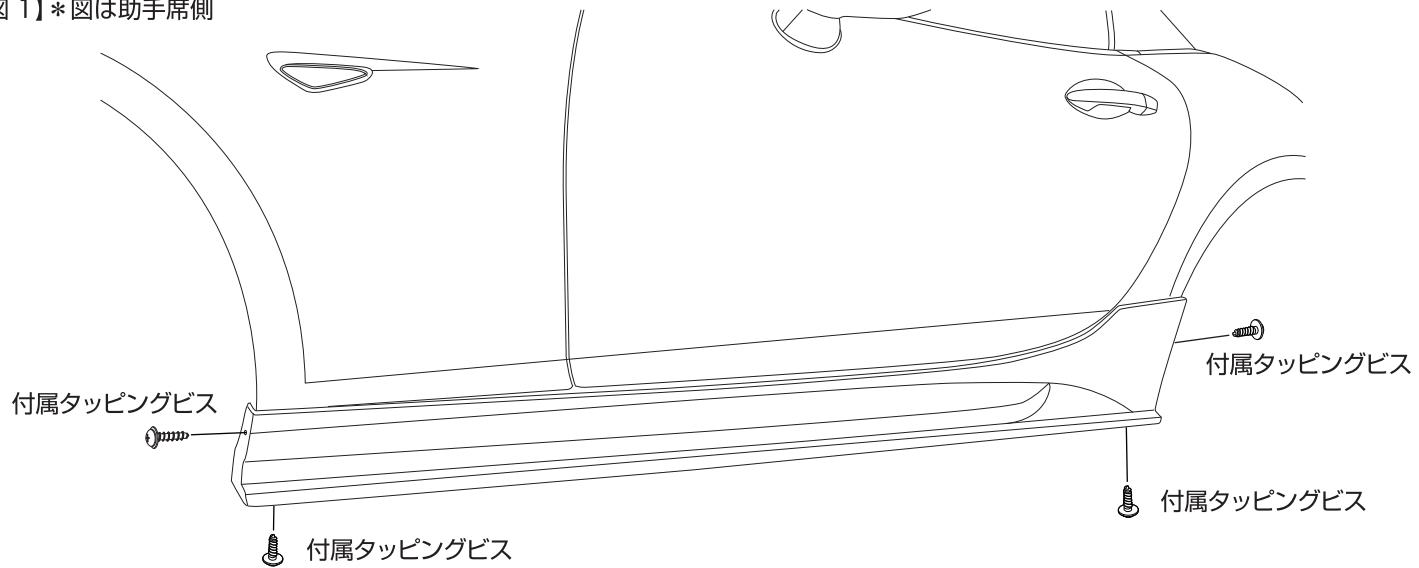
③取付けは、フロントタイヤハウス内及び、リヤタイヤハウス内に各1箇所、底面に2箇所取付けます。
