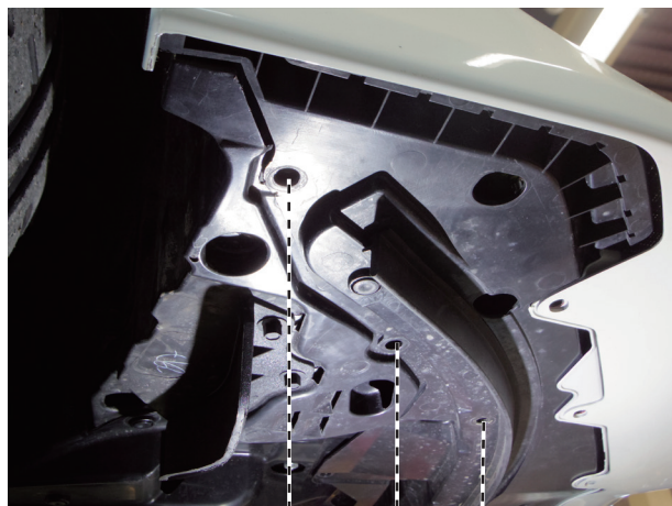
全6ヶ所のボルトを取り外して下さい。
