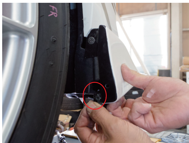
純正アンダーパネル両サイド部分を約2mm程カットすると干渉部分がスムーズに取り付けられます。
