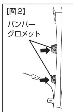
⑤バンパーリテナー及びバンパーグロメットを純正同様に、F/Bに移設します。（図1/図2参照）
