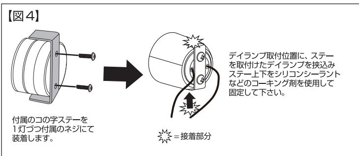
⑦付属のDAY LIGHT（以下D/L）をF/Bに取付けます。D/L付属の取扱説明書を参考の上、付属のビスを使用してD/Lに付属のコの字ステーを取付け、F/B裏側から取付位置に差込み装着位置を調整しながらコーキング剤等を使用して固定して下さい。
