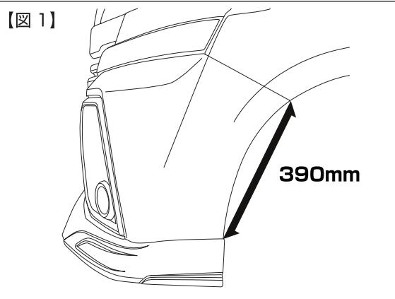
③F/Lを仮付けし、取付位置を確認したのち、取付位置をバンパーにマスキングテープ等を利用して、マーキングして下さい。この際取付け位置は図1を参照し、F/L後端部からバンパーエンドまでが390mm(±2)になるようにして下さい。（図1参照）
