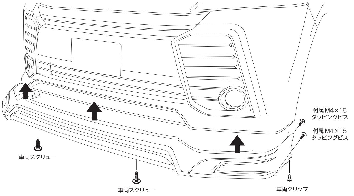
⑥F/Lを③にてマーキングした取付位置にしっかりと合わせ、F/Lをバンパーに被せます。図3を参照にF/Lを仮止めした後に、F/Lをバンパーから若干浮かせ、両面テープの剥離紙が切れないように徐々に剥がし、中央部分から外側に向かってF/Lを圧着しながら、浮きが出ないように両面テープ部分を貼付けます。
