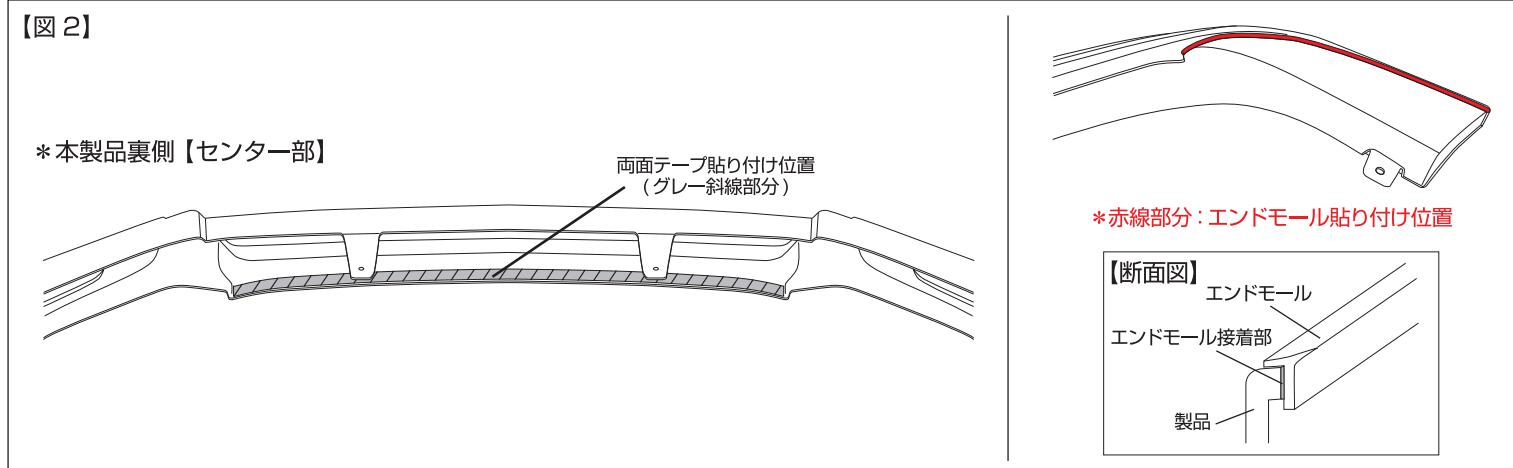
⑤付属のエンドモールと両面テープの取付け面を十分脱脂した後、付属のエンドモール及び両面テープをF/Lに貼り付けます。
