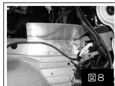
図6 ヒートプレート ※折り角度を約90度します。
