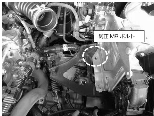
2. 画像の位置の純正 M8 ボルトを取り外します。
