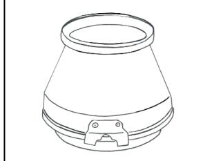
ロックプレートを、M4 六角頭ビスを使用して組み付けます。
