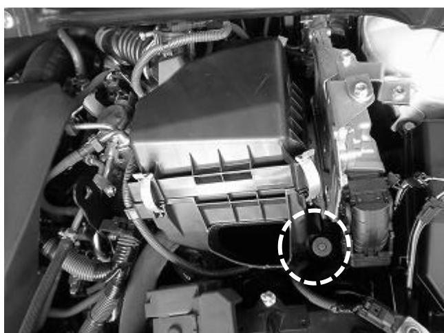
3. エアクリーナーBOX下側のボルトを外し、エアクリーナーBOX上蓋、エアフィルター、エアクリーナーBOX下側の順に車体より取り外します。
