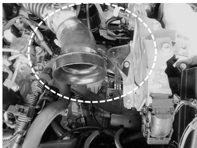
3. 純正サクションホースに、1.で組み立てたアタッチメントのエアフロアダプターを差し込み、2.で外したボルトを使用してステーを取り付けます。
