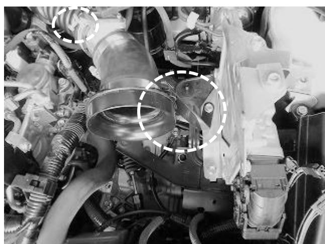
5. アタッチメントを再度車体へ取り付け、純正ホースバンド→純正 M8 ボルト→M6×20 の順に本締めします。
