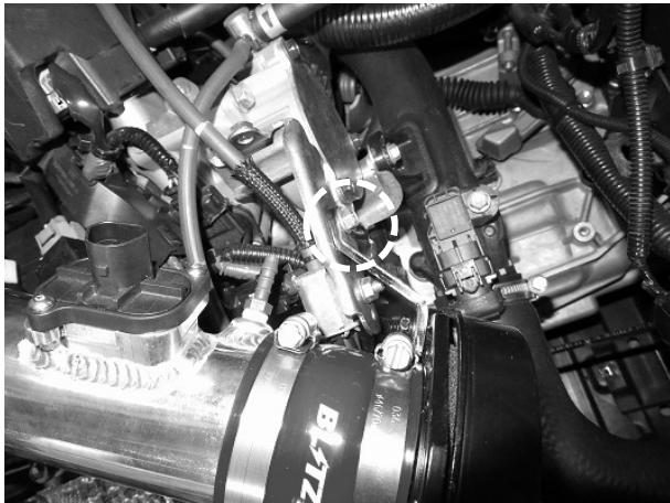
8. ステーNo.1を純正インテークダクトが取り付けされていた箇所へ付属のボルトM6×15を使用し仮付けします。
