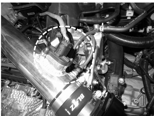
9. エアフロセンサーにコネクターを取り付けてください。
