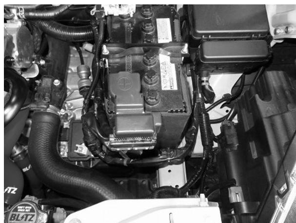
3. バッテリートリミッターハーネスクリップを取り外し、+端子の向きを画像のように合わせてください。
