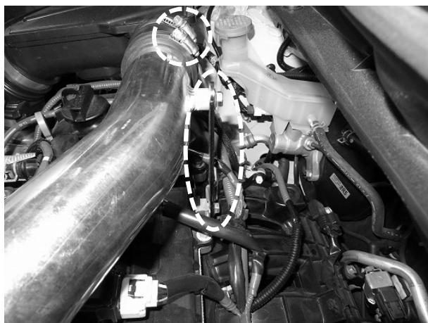
7. 5で外した純正ボルトを使用しステーNo,2 を仮付けします。
