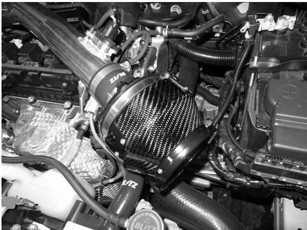
10. アダプターにフィルターを取り付けて、各部に干渉しない様、位置調整を行います。
