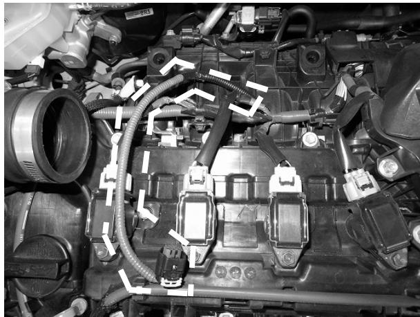
4. エアフロセンサー ハーネスのクリップを取り外し、ハーネスの集合体から分離させ図を参考にビニールテープを使用し絶縁処理をしてください。
