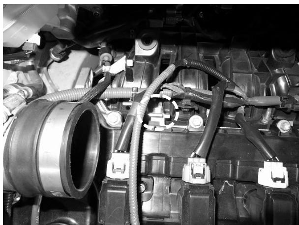
5. 印部分の純正ステー 固定ボルトを一度取り外します。
