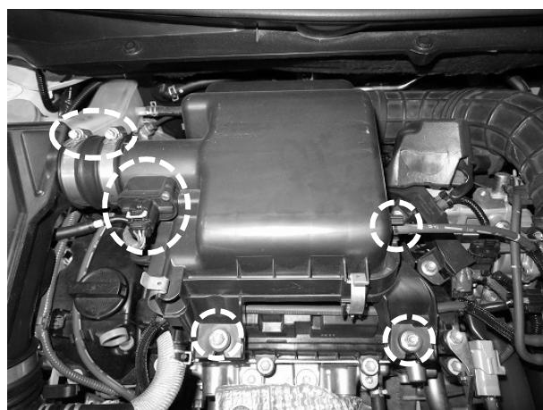
2. エアクリーナーBOXに接続されているΦ6バキュームホース、エアフロセンサーを取り外してください。
