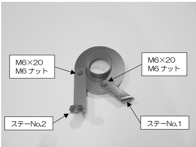
1. 画像を参考にステーNo.1とステーNo.2をボルトM6×20とM6ナットを使用しアダプターに取付けます。
