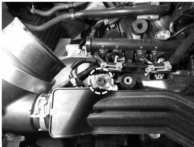
3. 印部分の純正ボルトを取外します。
