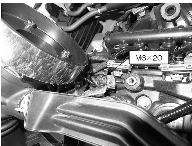
3. 組み立てたアダプターをサクションホースに接続しステーNo.1をM6×20のボルトを使用し取付けます。
