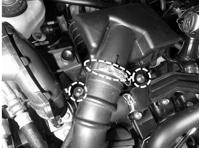
1. ボルト 2 本と純正バンドを取り外し、エアクリーナーBOX を取外します。
