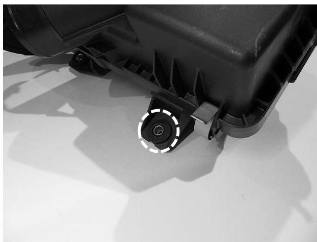
2. 取り外した純正クリーナーBOX から固定用のゴムワッシャーとカラーを 1 箇所取外します。
