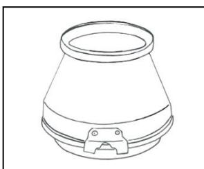
ロックフレートを、M4六角頭ビスを使用して組み付けます。
