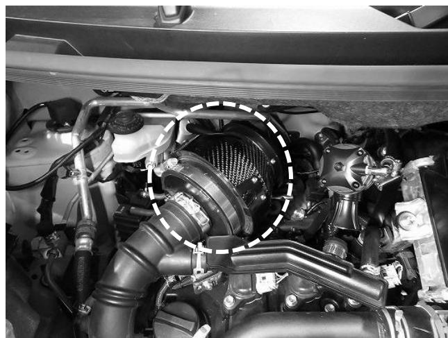
4. フィルターをアダプターに取付けし、ホースバンドを本締めします。
