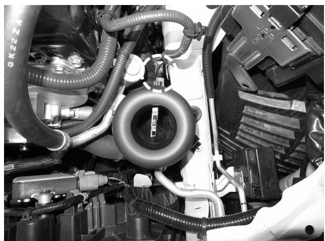
4. フィルターをアダプターに取付けしホースバンドを締め付けます。
