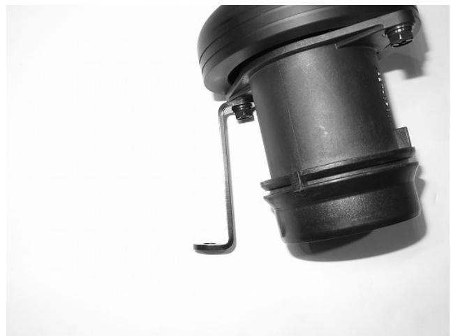
2. 組み立てたエアフロアダプターを車両に取付けます。ステーを M6×15 ボルトで仮固定します。
