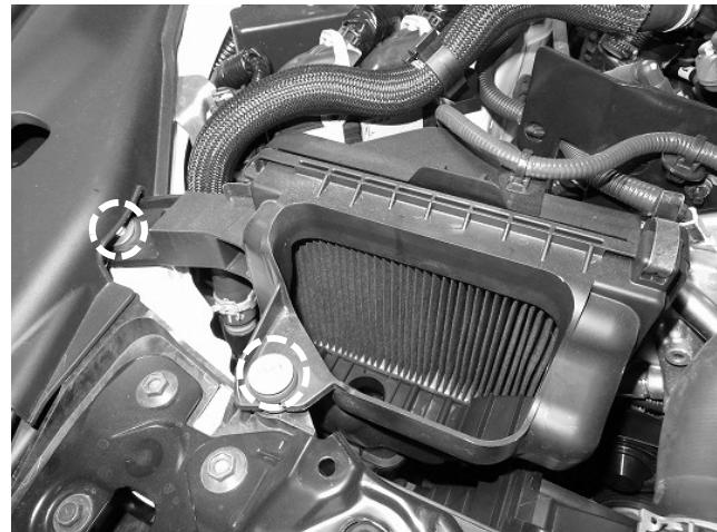
3. エアフロセンサーカプラーとハーネスクリップを取り外し、純正ホースバンド緩めて、残っている純正クリーナーBOX を取り外します。
