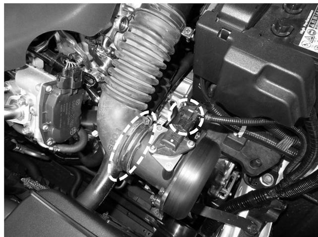
6. 仮締めボルトを本締めしてからフィルターをアダプターに取付けし、ホースバンドで締め付けます。
