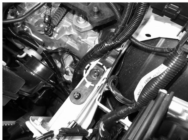
4. 組み立てたエアフロアダプターを車両に取付けます。M8×35mm のボルトを使用し手順3で設置したカラーの場所に固定します。
