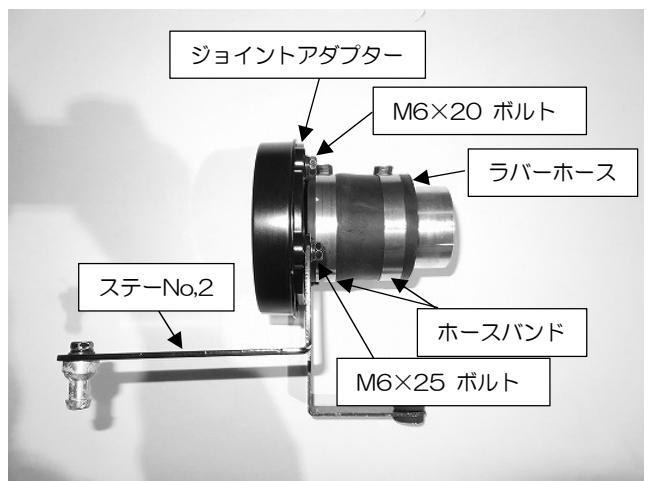
2. 純正クリーナーBOXから取外したゴムワッシャーとカラーをステーNo.1に取付けします。ステーNo.2にアルミスタッドをM6×30 ボルトを使用し取付けます。
