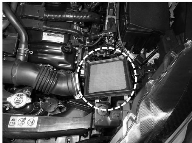
3. クリーナーBOX 下部を取外し、クリップボルト 1 個所を取外します。
