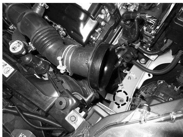
4. エアフロセンサーカプラーを取付けし仮締めめのボルトを本締めしてからフィルターをアダプターに取付けします。エアフロセンサーハーネスはエンジンルーム内で暴れないよう、タイラップで固定してください。
