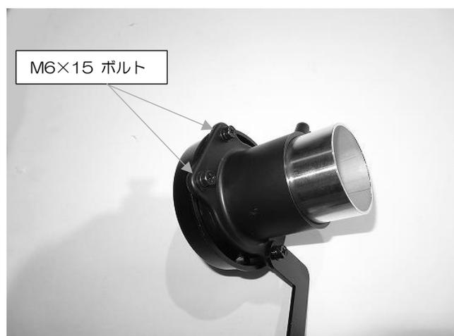
2. 純正クリーナー-BOX からエアフロセンサーを移植します。
