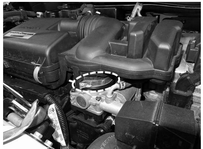
5. ボルト 2 個所を取り外し、純正クリーナーBOX を車両から取り外します。
