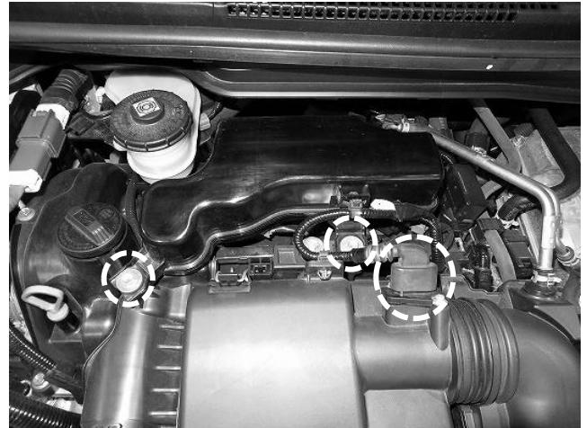
3. 純正クリーナーBOX に接続されているプローバイホースを取り外します。
