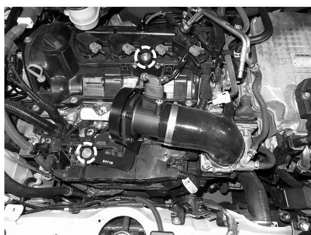
6. シリコンホースにストレートニップルを取付けし、ゴムホースを純正ブローバイパイプに接続します。エアフロセンサーのカプラーを接続してください。
