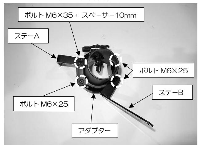
6. エアフロアダプターとステーAの間にスペーサー10mmをセットしてください。ステーAは短いほうをエアフロアダプター側に取り付けしてください。
