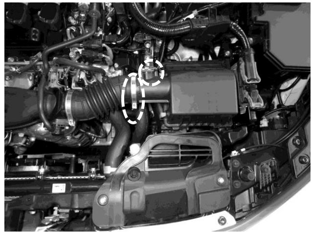
3. ボルト 2 本を取り外し、純正クリーナーBOX を導入ダクトごと取り外します。
