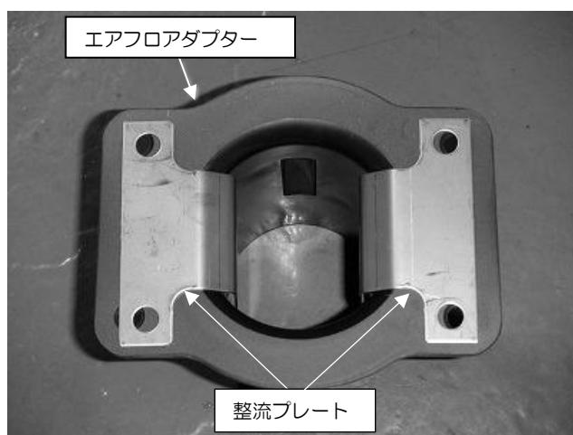
3. エアフロアダプター、アダプター、ステー、ヒートプレートを下記画像のように仮組みします。
