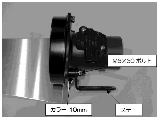
5. 下記画像を参考に純正ボルトを取り外したのち、カラー15mm、M6×30 ボルトを使用して仮組みしたエアフロアダプターASSY を車両側へ取り付けしてください。
