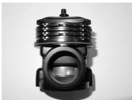
アイドリング時ピストンが 閉じている状態 (正常)
