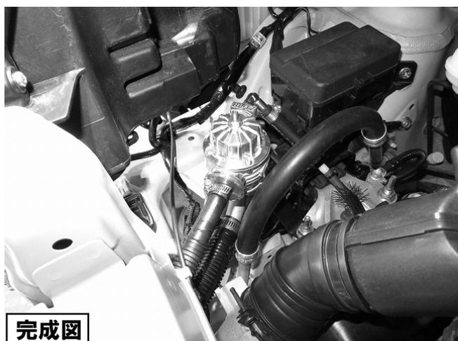
※写真はブローオフバルブVDの取り付け例ですが、ブローオフバルブBRにおいても同様に取付けてください。
