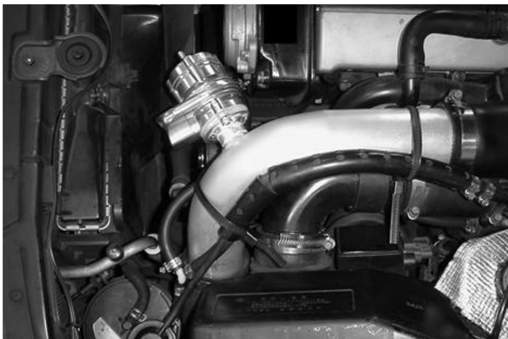
**お願い** 取り付けたプローオフDDと、周囲の純正品とのクリアランスを十分に確保してクランプを固定して下さい。
