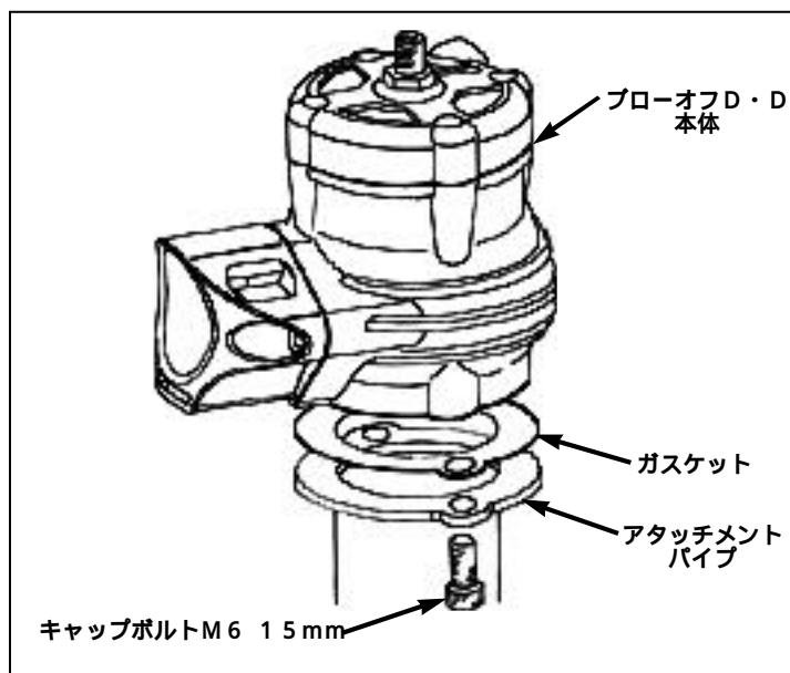
(2) プローオフDD本体を組み付けたアタッチメントを図のように取り付けて下さい。
