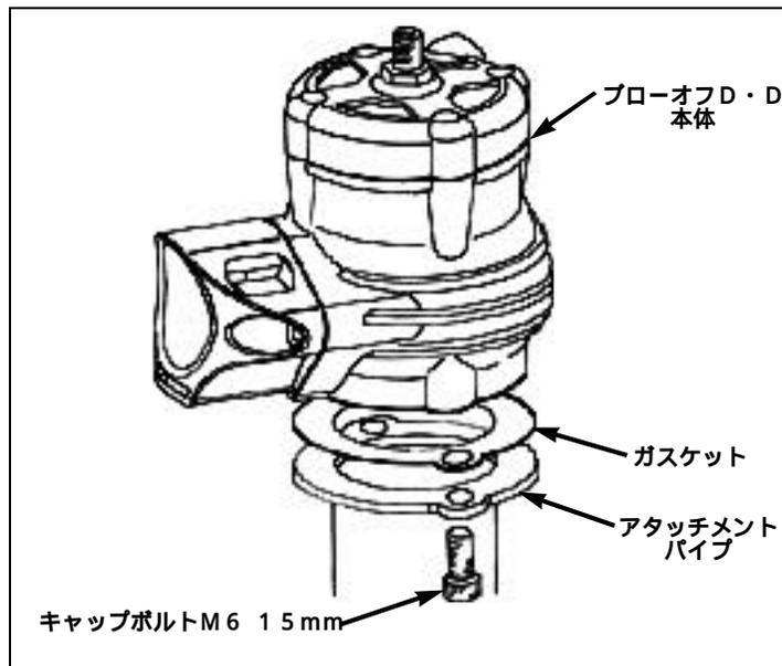
(2) ブローオフDD本体を組み付けたアタッチメントを図のように取り付けて下さい。
