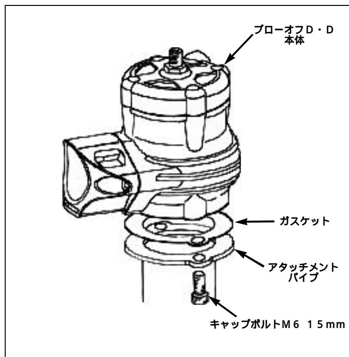
(3)(2)で組み付けたブローオフDD本体を、付属のゴムホースを使用して図のように純正のクランプを使用して取り付けて下さい。
