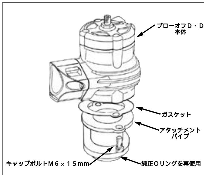
(3)(2)で組み付けたブローオフDDを下図のように取り付けてください。
