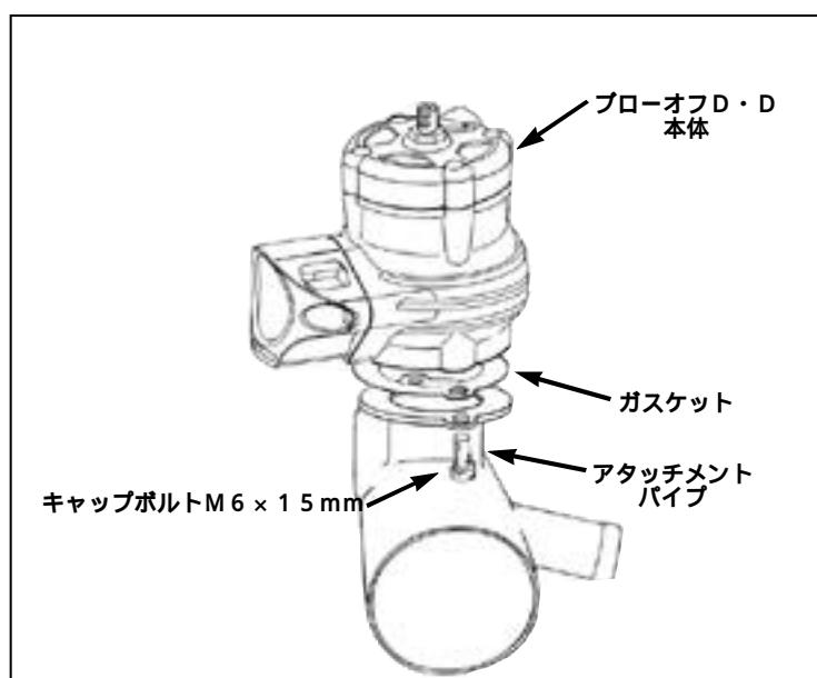
(3)(2)で組み付けたブローオフDD本体を図のように純正のクランプを使用して取り付けて下さい。
