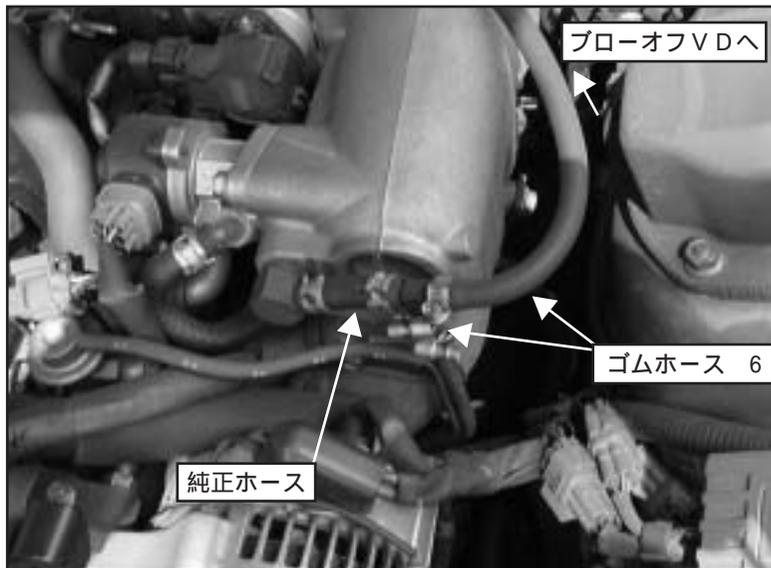
エンジン上部のゴムホースは、付属のタイラップでエンジン上部のブローバイホース配管へ固定してください。
