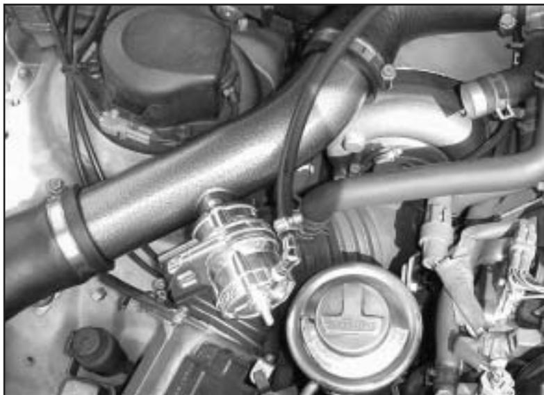
写真はブローオフバルブDD取り付け例ですが、ブローオフバルブVDにおいても取り付け方法は同様です。
