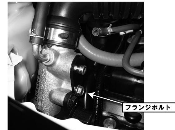
(2) 図のようにアタッチメントへゴムホースφ19を仮付けします。付属のバンド大を使用します。
