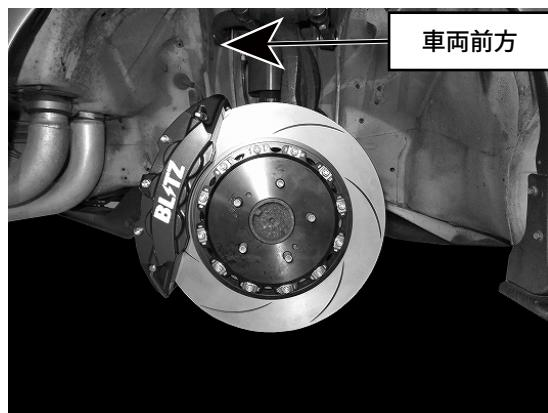
3. キャリパーブラケット、キャリパーボルトを規定トルクで締め付けます。
