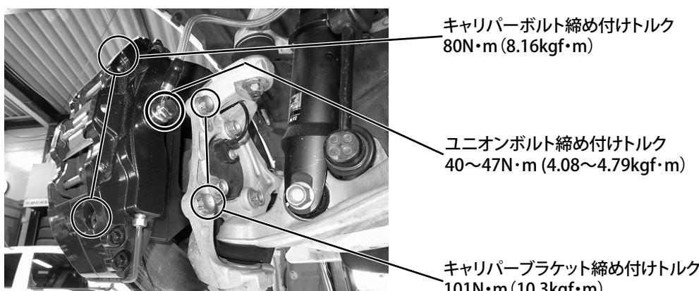
5. ブレーキホースユニバーサルジョイントに付属のブレーキホースステーNo.1を設置し、(運転席側にはステーNo.2を使用します)
