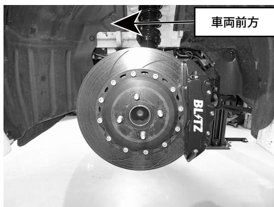
3. キャリパーブラケット、キャリパーボルトを規定トルクで締め付けてください。
