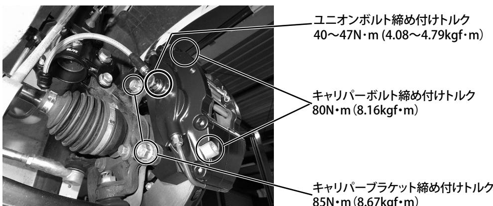
5. ブレーキホースユニバーサルジョイントに付属のブレーキホースステーを取付し、純正ボルトを使用して車両へ取付けてください。
