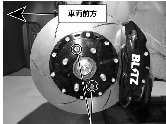
ローター固定ボルト締め付けトルク
