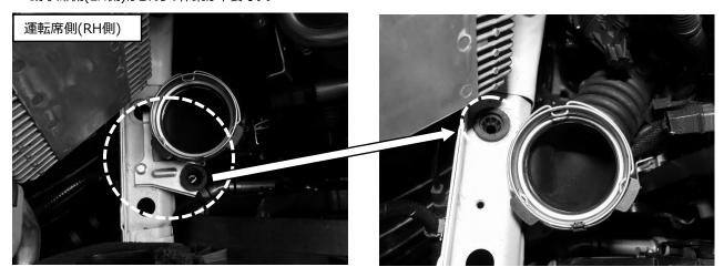
10) 運転席側(RH側)のエンジン側に取り付けられた純正ボルトを取り外し、純正ブラケットを取り外します。
