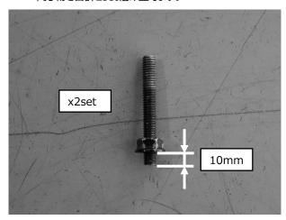
17)前の手順で組み立てたスタッドボルトを車両の左右に取り付け、ナットM6を締め付けます。 締め付けたナットM6の上にキット付属のカラーを設置します。
