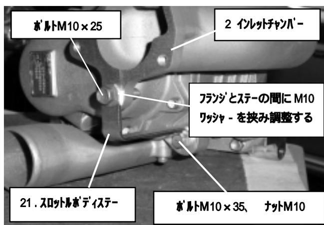
(16)2.インレットチャンバーフランジ下部、M10ネジ穴部分と1.コンプレッサー本体右奥の11部分を21.スロットルボディステー、フランジボルトM10×25、小型六角ボルトM10×35、フランジナットM10で締付ける。
