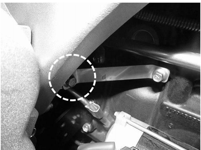
11. エンジンブロックに取付しておいたステーBをパーツリスト No.15 の M8 ボルトを使用し、インテークマニホールド下部右側のネジ穴に固定します。
