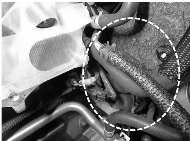
1. インテークマニホールド右側につながっていた短いホースを取り外し、パーツリスト No.13 のΦ8 ホースを取付します。取付後 No.14 のホースバンドで締め付けて下さい。
