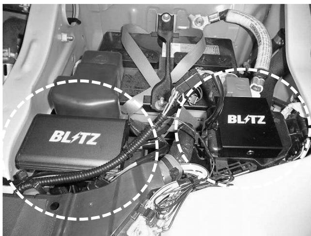
26. パーツリスト No.33,35 フューエルコントローラー、エアフロコントローラーの本体を設置します。
