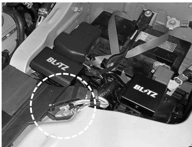
28. キット取付作業の手順 18 で取付したフューエルコントローラーハーネスのアース線を左図のアースポイントに共締めします。
