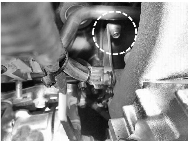
8. コンプレッサ本体をエンジンルーム内に入れ、ステーAをパーツリスト No.15 の M8 ボルトを使用してエンジンブロックに固定します。
