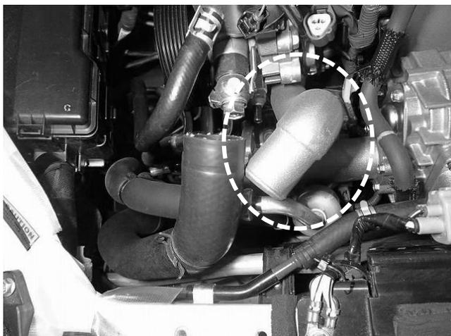
12. 新品の純正ガスケットを使用し、パーツリスト No.2 のウォータアウトレットパイプを取付し、ウォータホースを差し込みます。
