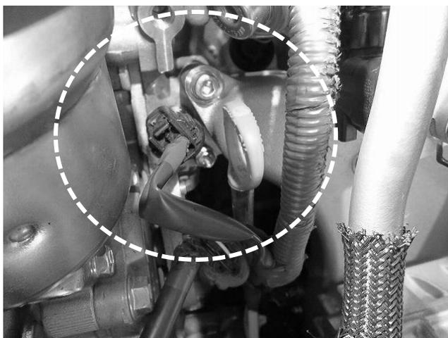
23. 純正インテークマニホールドを外す際に外したコネクタ類、オイルレベルゲージを取付します。
