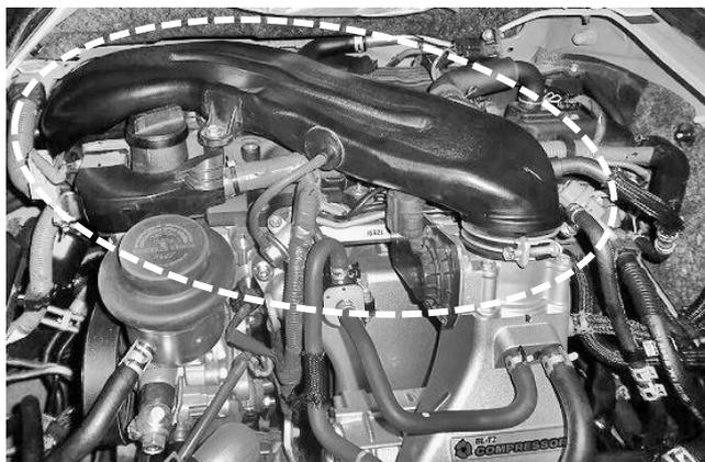
25. 純正ボルト、クランプを使用して、サクションパイプを取付し、ホース類を接続して下さい。
