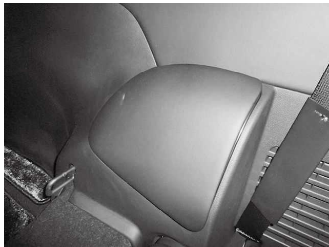
サービスパネル取り付け状態
