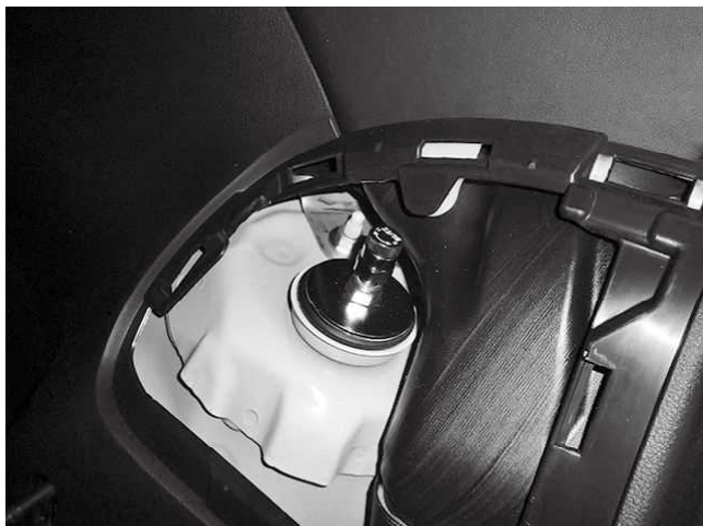
トップナット締め付け状態
