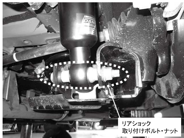
リアショック取り付けボルト・ナット 1カ所締め付け 締め付けトルク: 67\text{N}\cdot\text{m} ( 6.8\text{kgf}\cdot\text{m} )
