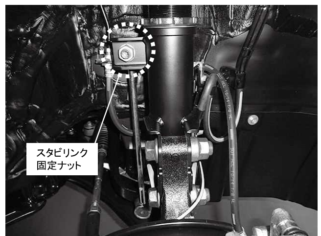
スタビリンク固定ナット 1カ所締め付け 締め付けトルク: 74N・m(7.5kgf・m)
