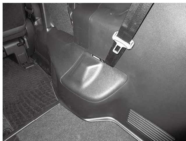
左右ともにリアショックに減衰ダイヤルを装着した状態でも、 ショック上部のサービスパネルは装着可能です ※車両個体差で内側と干渉する場合は加工してください
