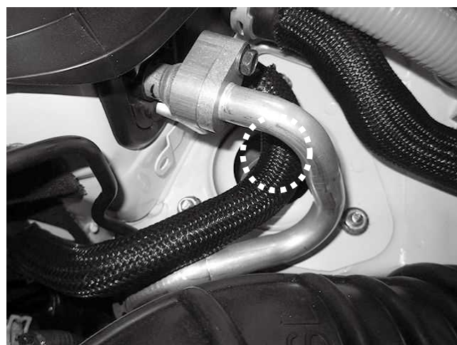
フロント左側(助手席側)取り付け状態 減衰調整ダイヤル上部に車両側ハーネスが通っているため手が入りづらくなっています
