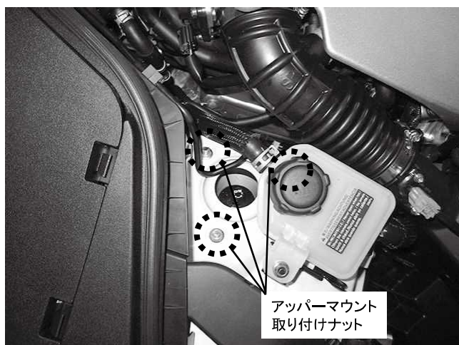
アッパーマウント取り付けナット 3カ所締め付け 締め付けトルク: 38N・m(3.9kgf・m)
