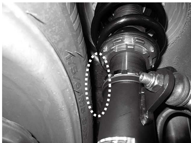
ホイール・タイヤとショックとの干渉に 注意してください ※写真は純正15インチタイヤ・ホイールを スペーサー無で装着しています
