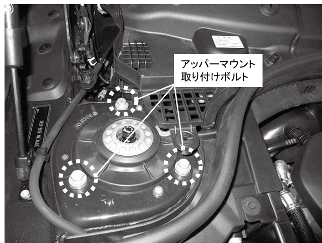
アッパーマウント取り付けボルト 3カ所締め付け 締め付けトルク: 30\text{N}\cdot\text{m} ( 3.0\text{kgf}\cdot\text{m} ) + 90^\circ
