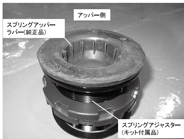
リアアジャスター取り付け状態 ※スプリングアジャスターをボディ上部に取り付けの際、 スプリングアジャスター上部に純正スプリング アッパーラバー(インシュレーター)を取り付けてください
