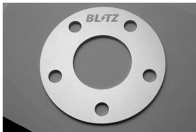
装着するホイール・タイヤサイズによっては ショックアブソーバーと干渉するため 同梱ホイールスペーサー(5mm)を使用してください ※5mmであれば純正ホイールボルトの使用が可能です ※フェンダーからのホイール・タイヤのはみ出しに注意してください
