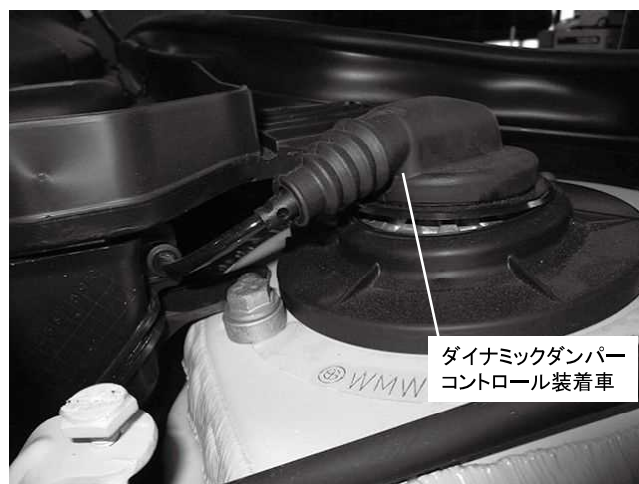
純正オプション「ダイナミックダンパーコントロール」 装着車は本キットの取り付けはできません 装着車用製品(品番: 92330)をご使用ください
