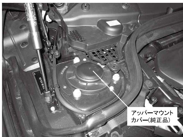
アッパーマウントカバー(純正品)は 真ん中の部分のみ取り外して使用可能です
