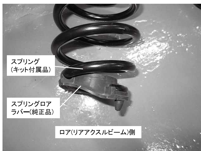
リアスプリング取り付け状態 ※スプリングをリアアクスルビームに取り付けの際、 スプリング下部に純正スプリング ロアラバー(インシュレーター)を取り付けてください
