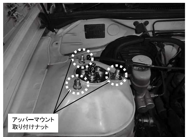
アッパーマウント取り付けナット 3カ所締め付け 締め付けトルク: 54N・m(5.5kgf・m) ※製品付属のM10ナットを使用してください
