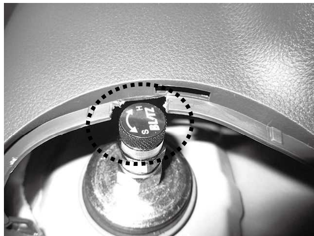
リア右側減衰調整ダイヤル取り付け状態(LA600S) 左右とも減衰調整ダイヤルと内装パネルが干渉する ため干渉部分を加工してください サービスホールカバーの取り付けは可能です
