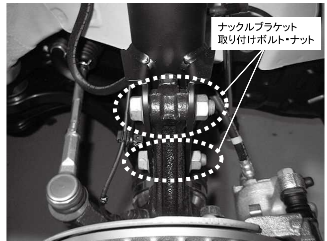
ナックルブラケット取り付けボルト・ナット 2カ所締め付け 締め付けトルク: 108N・m(11.0kgf・m)
